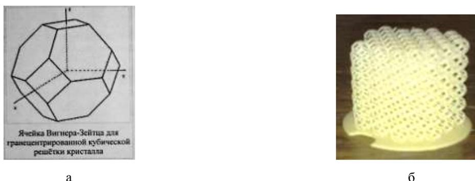
Рис. 3. а) схематичное изображение ячейки Вигнера-Зейтца, б) изделие из фотополимера, состоящее из ячеистой структуры
